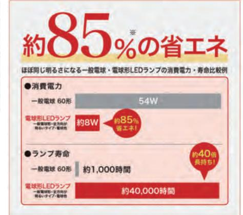
※ほぼ同じ明るさの一般電球と電球形LEDランプとの比較
