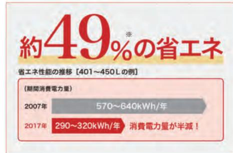
※定格内容積 401～450L の 10 年前冷蔵庫と最新冷蔵庫の比較・このデータは特定冷蔵庫の年間消費電力量を示したものではありません。・各年度毎に定格内容積 401～450L の冷蔵庫の年間消費電力量を推定した目安であり、幅をもたせて表示しています。・JIS C 9801-3 : 2015 による。出典：一般社団法人 日本電機工業会
