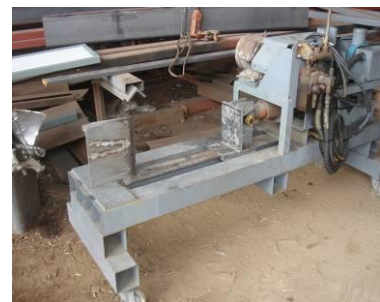
鉄板、チェッカープレートを切って 箱型にはりあわせただけのシンプルな作り
