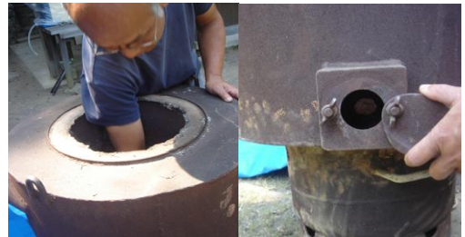
木炭と砂鉄を交互にいれ 羽口から空気を送って木炭を燃やす
