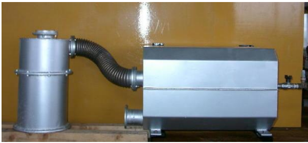
排気ガス浄化装置
