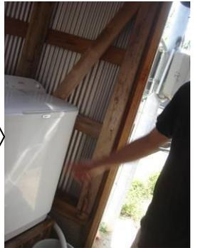
④脱水機で結晶と残母液を分離
